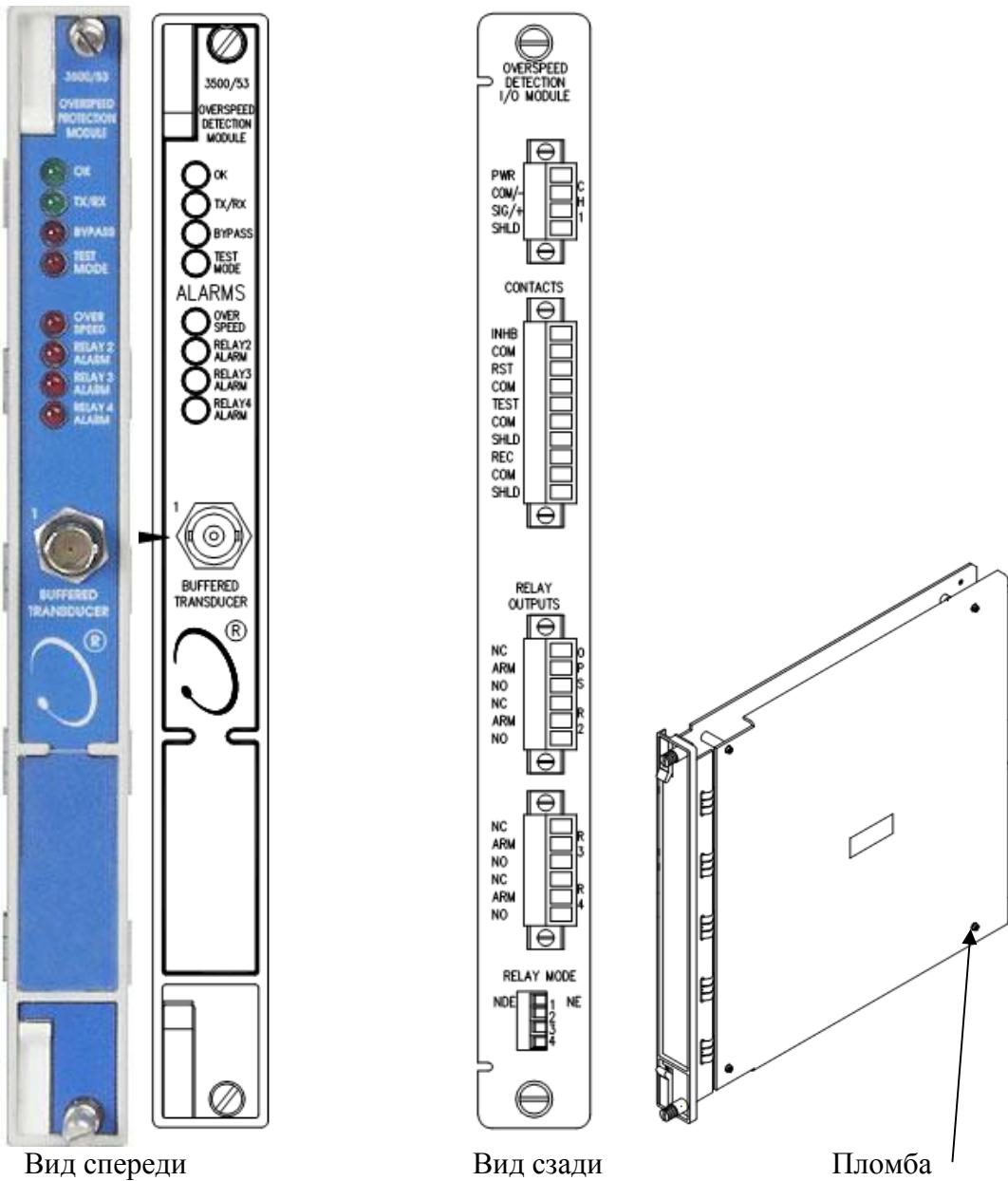
Рис. 1 Общий вид системы 3500/53, схема пломбировки от несанкционированного доступа
