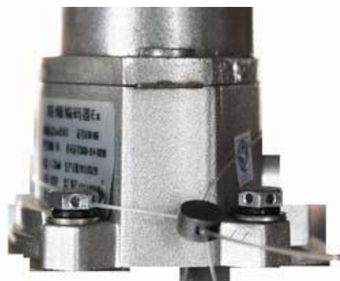
Рисунок 7 - Пломбировка датчика импульсов
