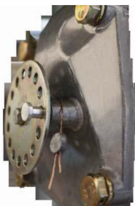
Рисунок 6 - Пломбировка регулировочного винта измерителя объема
