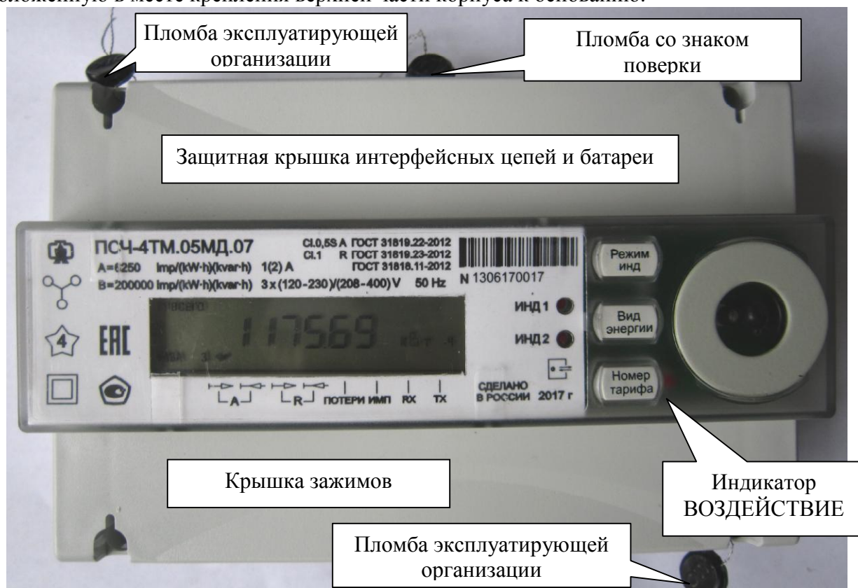
Рисунок 1 – Общий вид счетчика с закрытыми крышками, схема пломбировки от несанкционированного доступа, обозначение места нанесения знака поверки
