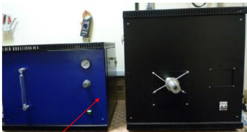
Рисунок 1 – Внешний вид анализаторов углерода и серы МЕТЭК-200 Место нанесения поверительного клейма (или знака поверки в виде наклейки)
