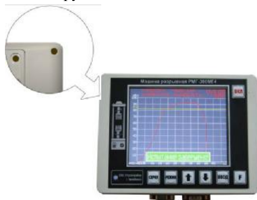
Рисунок 1 – Схема пломбирования от несанкционированного доступа
