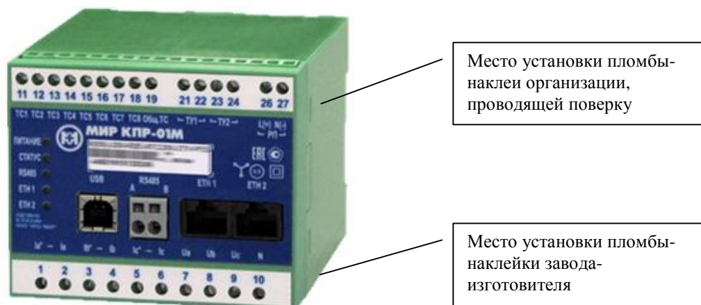
Рисунок 2 - Схема пломбировки от несанкционированного доступа
