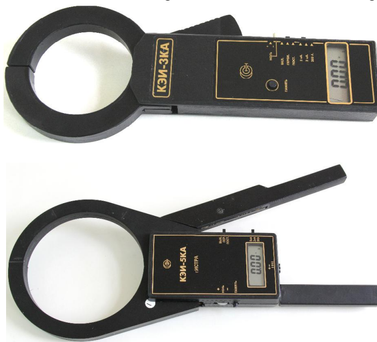
Рисунок 1 - Внешний вид клещей электроизмерительных КЭИ-3кА и КЭИ-5кА
