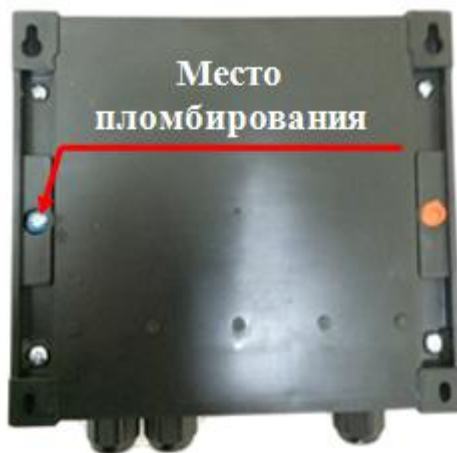
Рисунок 6 – Пломбирование тепловычислителя СПТ941
