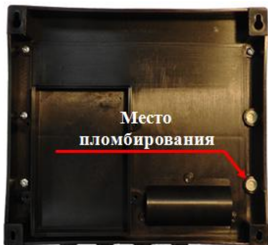
Рисунок 7 – Пломбирование тепловычислителя СПТ943
