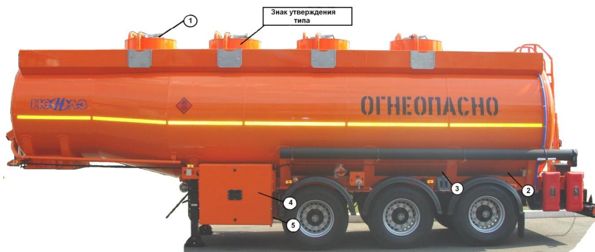
Рисунок 2 – Схема пломбировки от несанкционированного доступа
