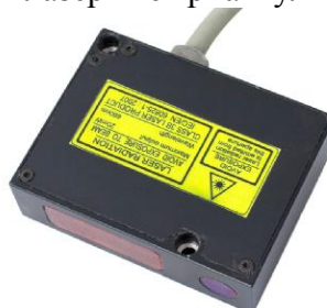
Рисунок 2 - Измерители лазерные триангуляционные РФ603
