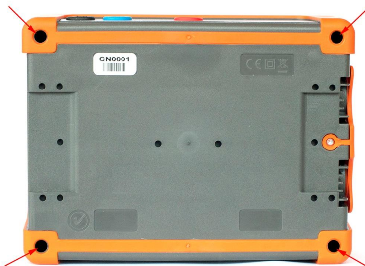
Рисунок 2 - Места пломбирования измерителей
