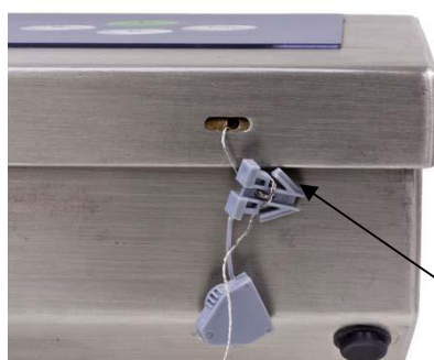
Рисунок 4 - Места пломбирования корпуса терминалов
