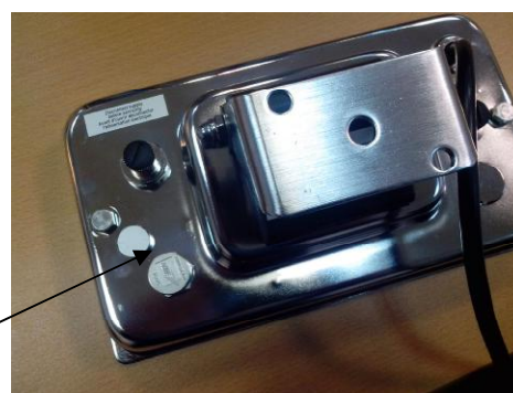
Рисунок 4 - Места пломбирования корпуса терминалов
