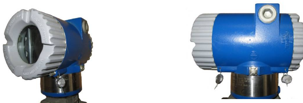
Рисунок 2 - Места опломбирования преобразователя давления
