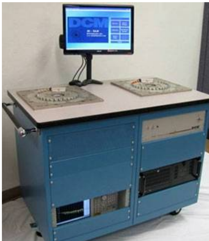
Рисунок 1 - Общий вид автоматизированной системы измерения кабелей 3S-XLD
