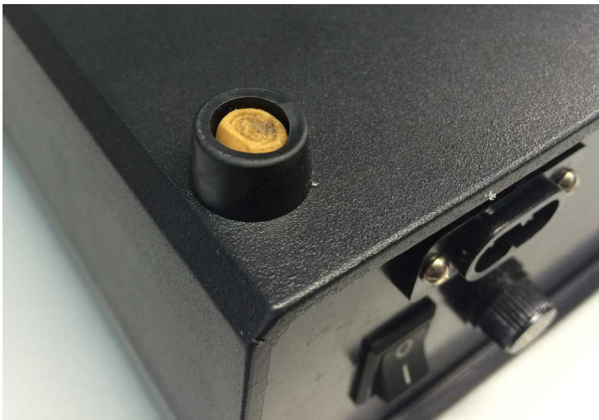
Рисунок 2 - Схема пломбировки от несанкционированного доступа
