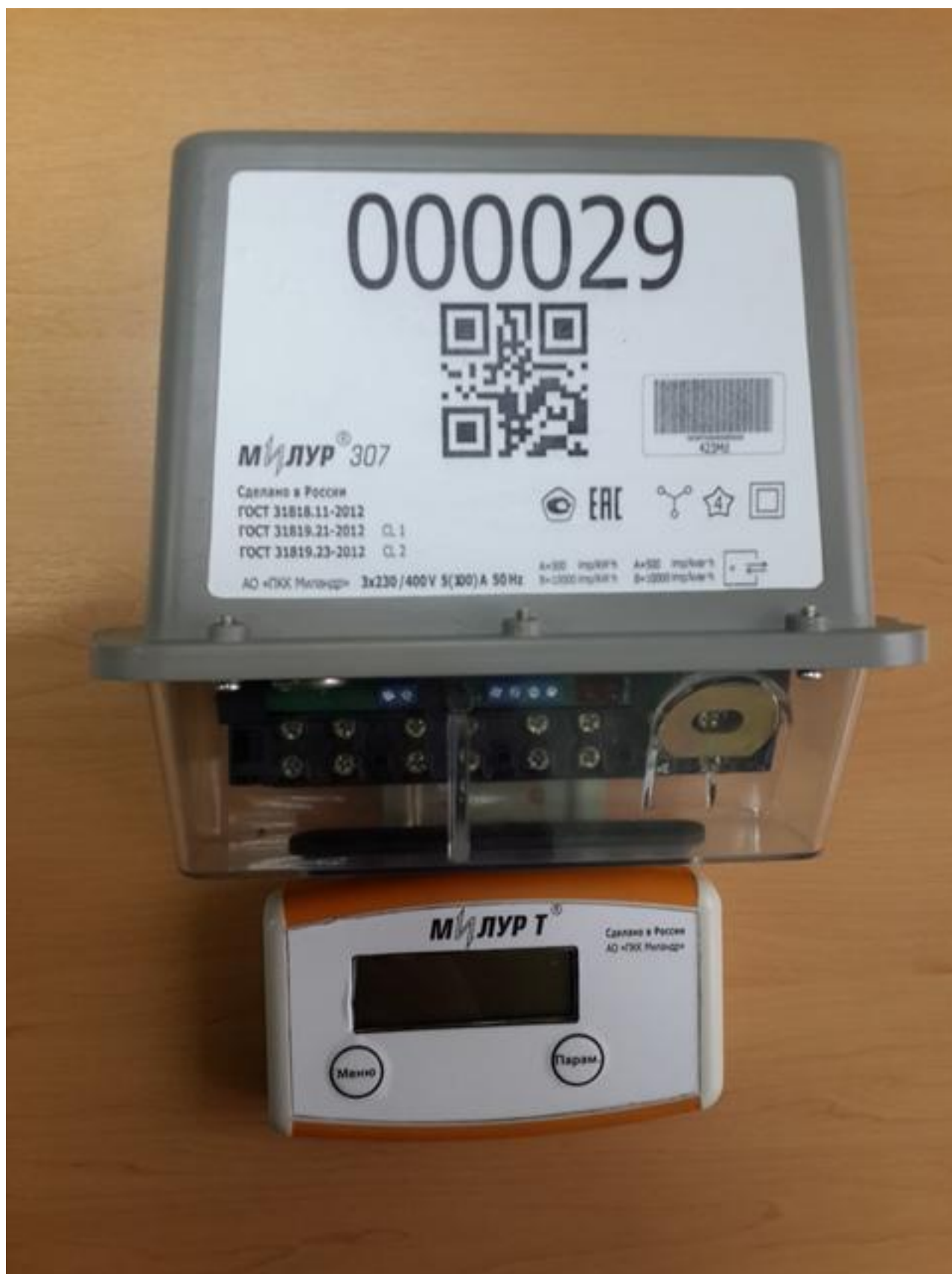
Рисунок 3 - Общий вид счетчиков в корпусе SPLIT (наружная установка)
