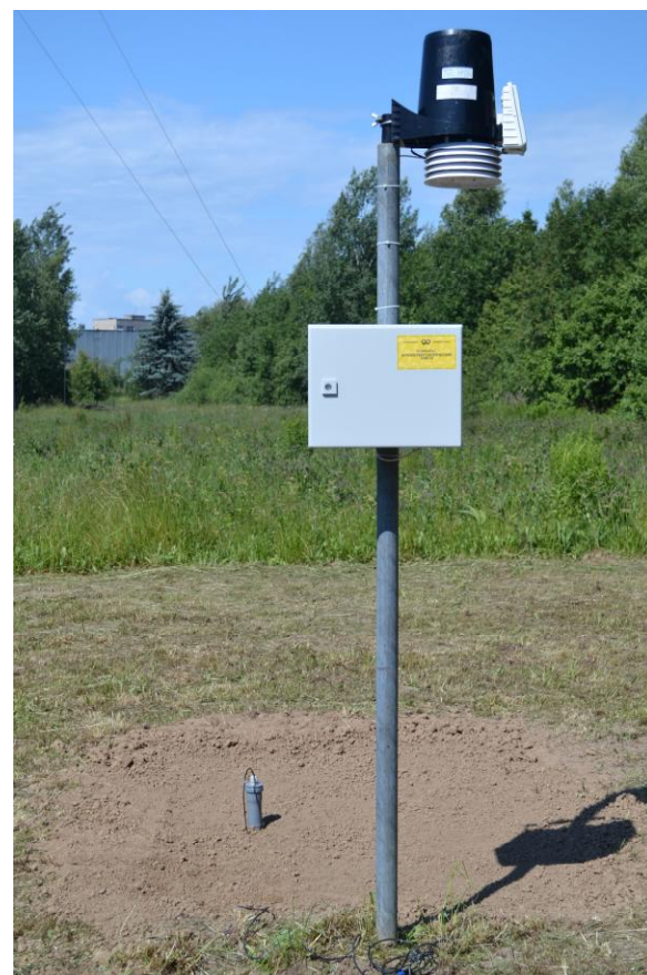
Датчик количества жидких осадков, датчик температуры и влажности воздуха в радиационной защите, защитный шкаф для блока БУ
