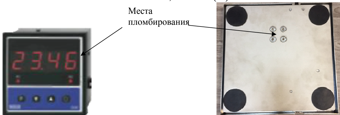
Рисунок 2 - Схема пломбировки от несанкционированного доступа установок модификации GCS-1
