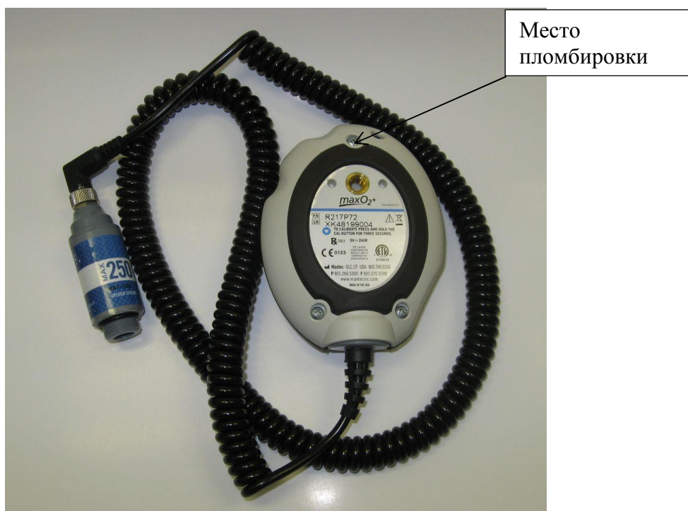
Рисунок 2 - Анализаторы кислорода MAXO 2 +/- схема пломбировки корпуса от несанкционированного доступа
