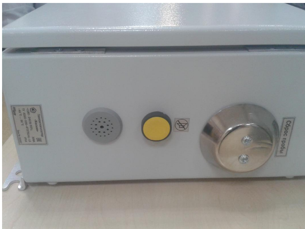
Рисунок 1 - Общий вид газосигнализатора, места пломбирования и маркировка
