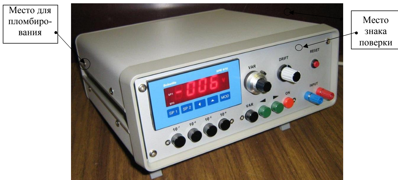
Рисунок 1 - Общий вид флюксометров, схема пломбировки от несанкционированного доступа, обозначение места нанесения знака поверки
