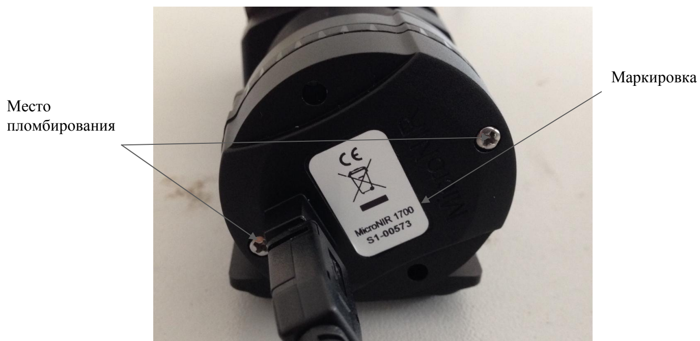
Рисунок 3 - Схема пломбировки и обозначение места нанесения маркировки
