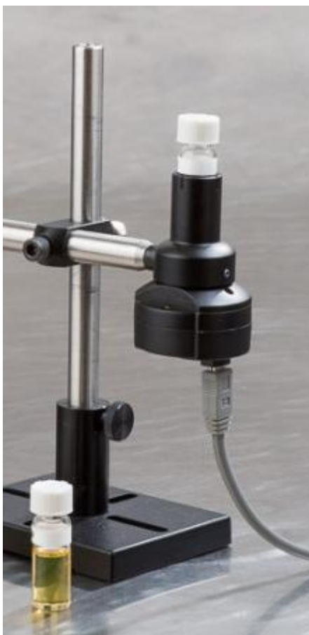
Рисунок 2 - Общий вид спектрометра диодноматричного БИК-диапазона MicroNIR с приспособлением для анализа в виалах на отражение
