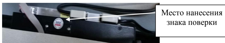
Рисунок 2 - Схема пломбирования от несанкционированного доступа, обозначение места нанесения знака поверки
