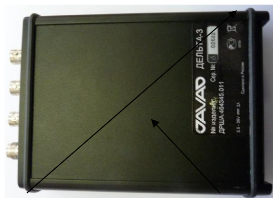
а - место пломбировки б - место нанесения наклейки со знаком утверждения типа (нижняя панель)
