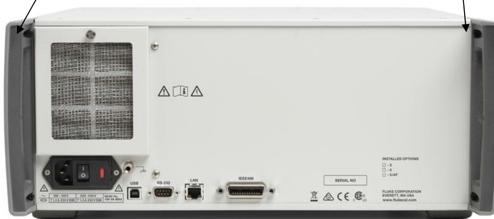
Рисунок 2 - Схема пломбировки от несанкционированного доступа
