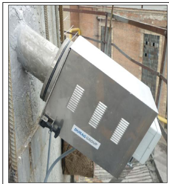
Рисунок 2 - Измеритель скорости потока D-FL-220 на месте установки (показан только один из двух блоков приемника-передатчика)
