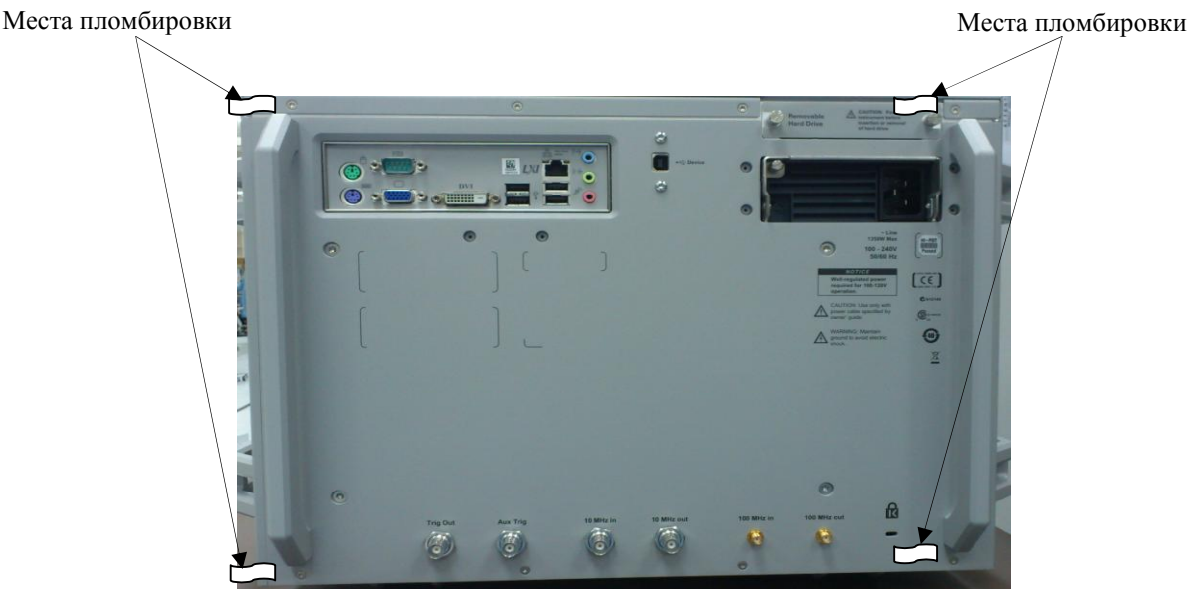
Рисунок 2 - Схема пломбировки от несанкционированного доступа
