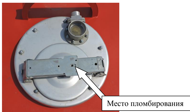
Рисунок 3 - Запорный механизм крышки заливной горловины ПЦ и ППЦ
