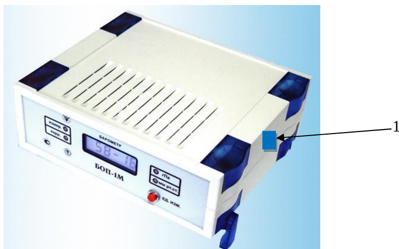
Рисунок 2 - Схема пломбирования стационарных поверочных наборов для средств измерений атмосферного давления СПН-1
