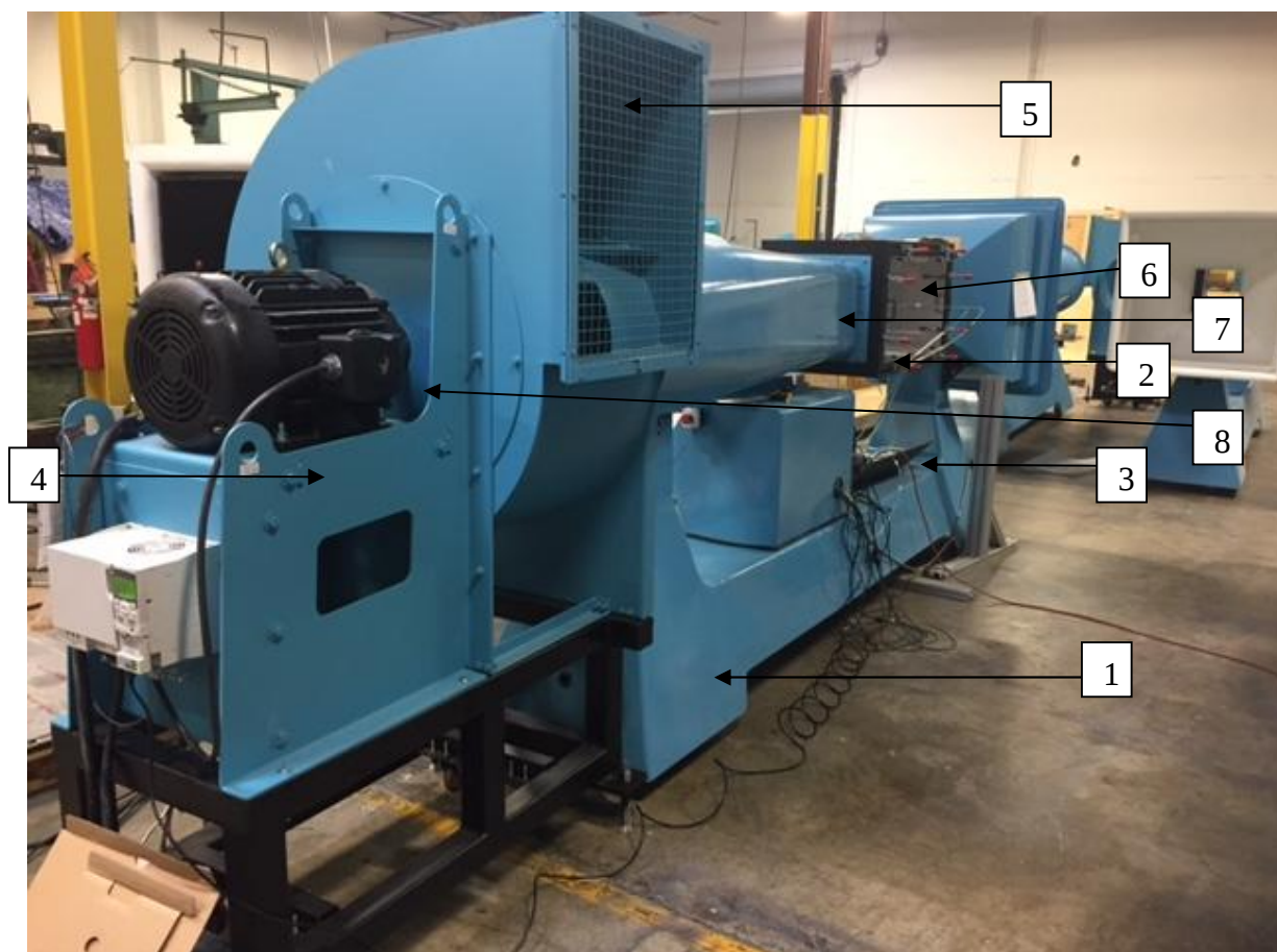
Рисунок 1 - Общий вид стационарных поверочных наборов для средств измерений параметров воздушного потока СПН-4
