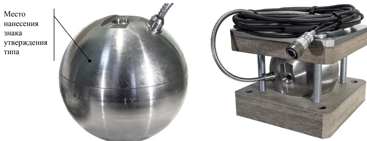
Рисунок 2 - Внешний вид датчика ускорения AP2013 и устройства крепления
