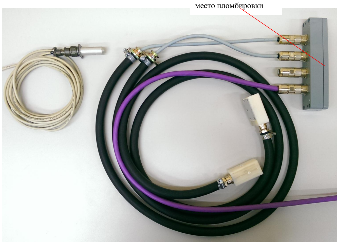
Рисунок 1 – Общий вид измерительных каналов системы СКТП-01, схема пломбировки от несанкционированного доступа
