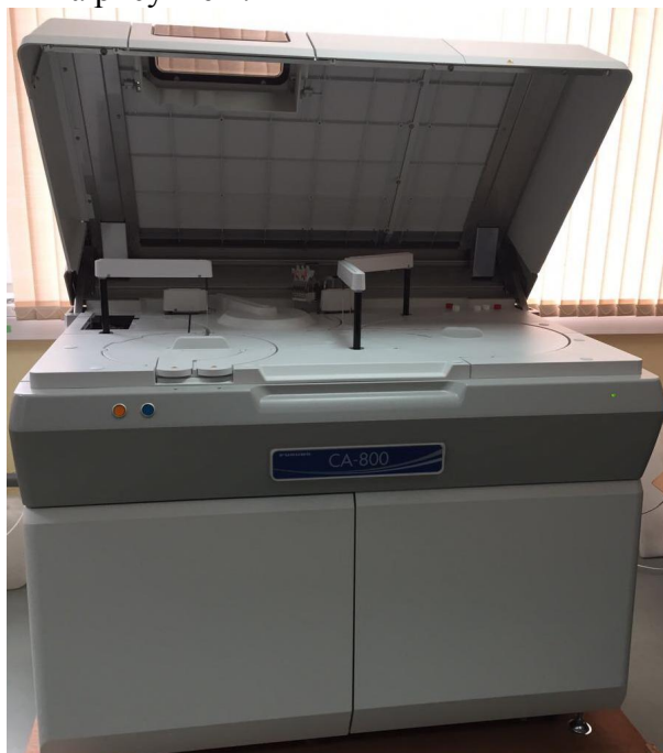
Рисунок 1 - Общий вид анализатора биохимического автоматического СА-800
