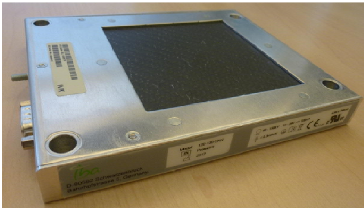
Рисунок 1 - Измеритель производства дозы на площадь KermaX plus 120-130 CAN
