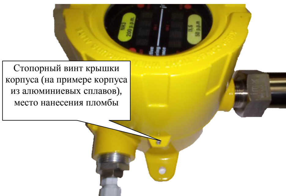
Рисунок 4 - Схема пломбировки датчиков от несанкционированного доступа
