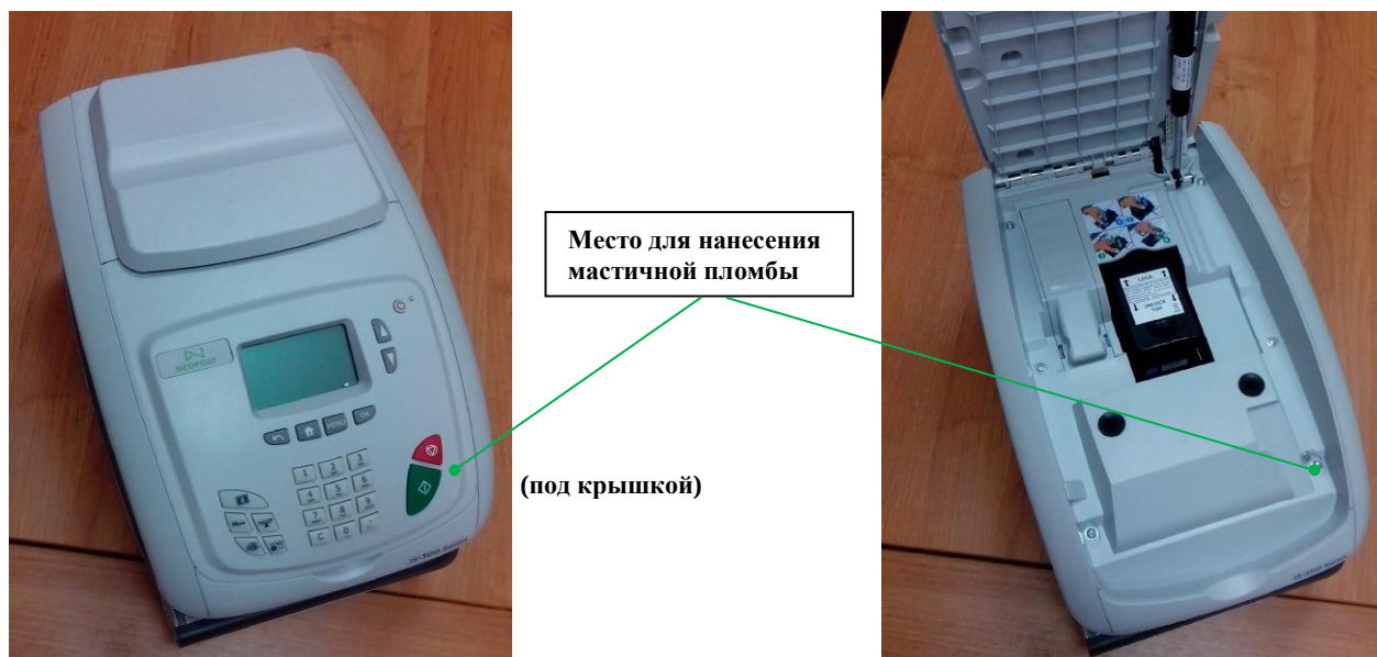
Рисунок 2 - Схема пломбировки от несанкционированного доступа
