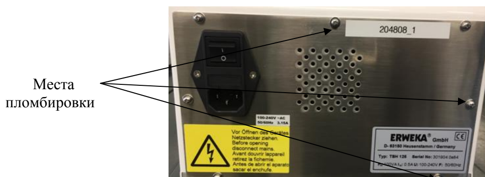
Рисунок 2 - Схема пломбировки тестеров модификаций ТВН 125, ТВН 125 500N, ТВН 125 D, ТВН 125 D 500N, ТВН 125 TD, ТВН 125 TD 500N от несанкционированного доступа
