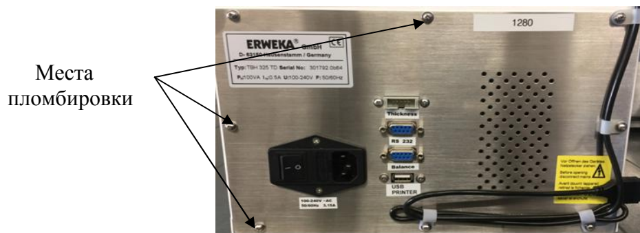
Рисунок 4 - Схема пломбировки тестеров модификаций ТВН 325, ТВН 325 1000N, ТВН 325 D, ТВН 325 D 1000N, ТВН 325 TD, ТВН 325 TD 1000N, ТВН 325 WTD, ТВН 325 WTD 1000N от несанкционированного доступа
