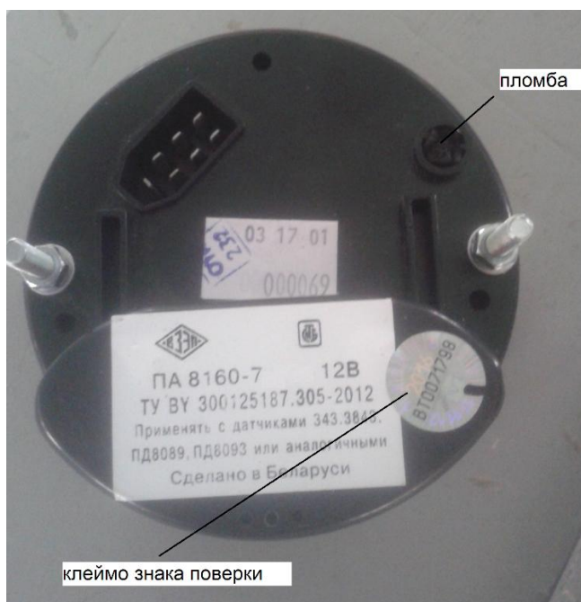
Рисунок 3 - Схема пломбировки от несанкционированного доступа, обозначение места нанесения знака поверки
