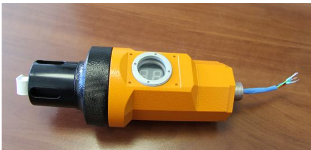
Рисунок 2 – Общий вид преобразователя газоаналитического универсального ПГУ-А с цифровым табло
