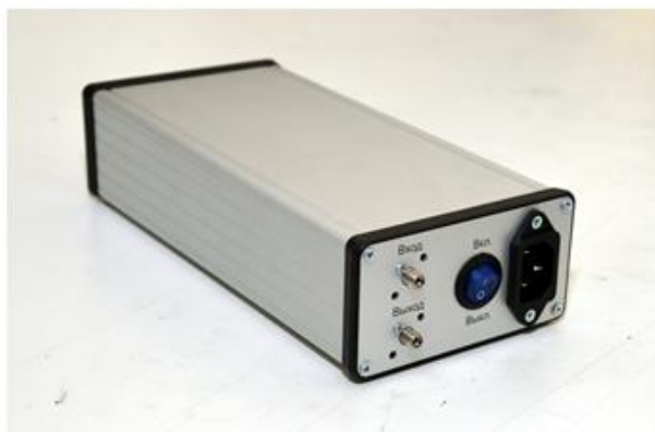
Рисунок 5 – Малошумящий усилитель RL-AMP-1-40
