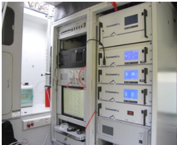
Рисунок 3 – Лаборатория экологического контроля в виде стационарного поста «Алмаз-01М» - стойка со средствами измерений
