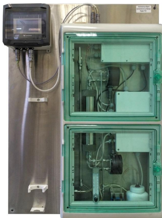
Рисунок 1 - Общий вид анализатора промышленного комбинированного «ЛИДЕР» с каналом общего органического углерода «ЛИДЕР-ТОС»
