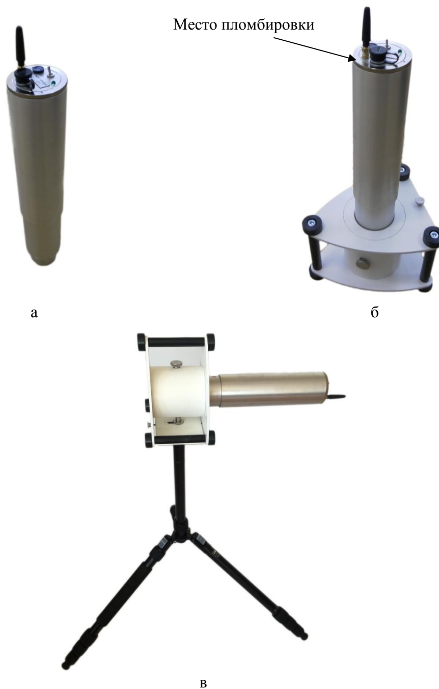
а – блок детектирования БДКС-38-02А б – блок детектирования БДКС-38-02А со свинцовым коллиматором в – блок детектирования БДКС-38-02А со свинцовым коллиматором, установленный на кронштейне
