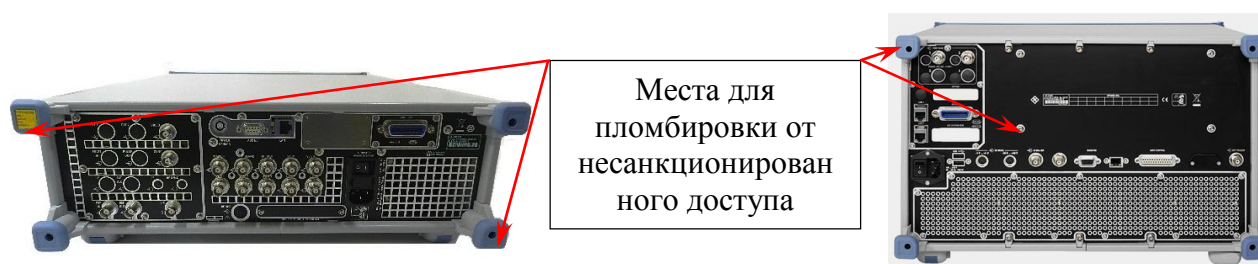
Рисунок 14 – Задняя панель генератора сигналов и векторного анализатора цепей
