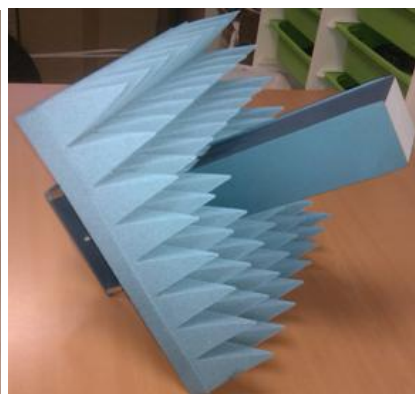
Рисунок 5 – Внешний вид антенн-зондов диапазона частот от 1 до 4 ГГц
