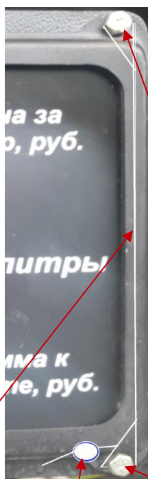
Рисунок 2 – Пломбирование измерителя объема
