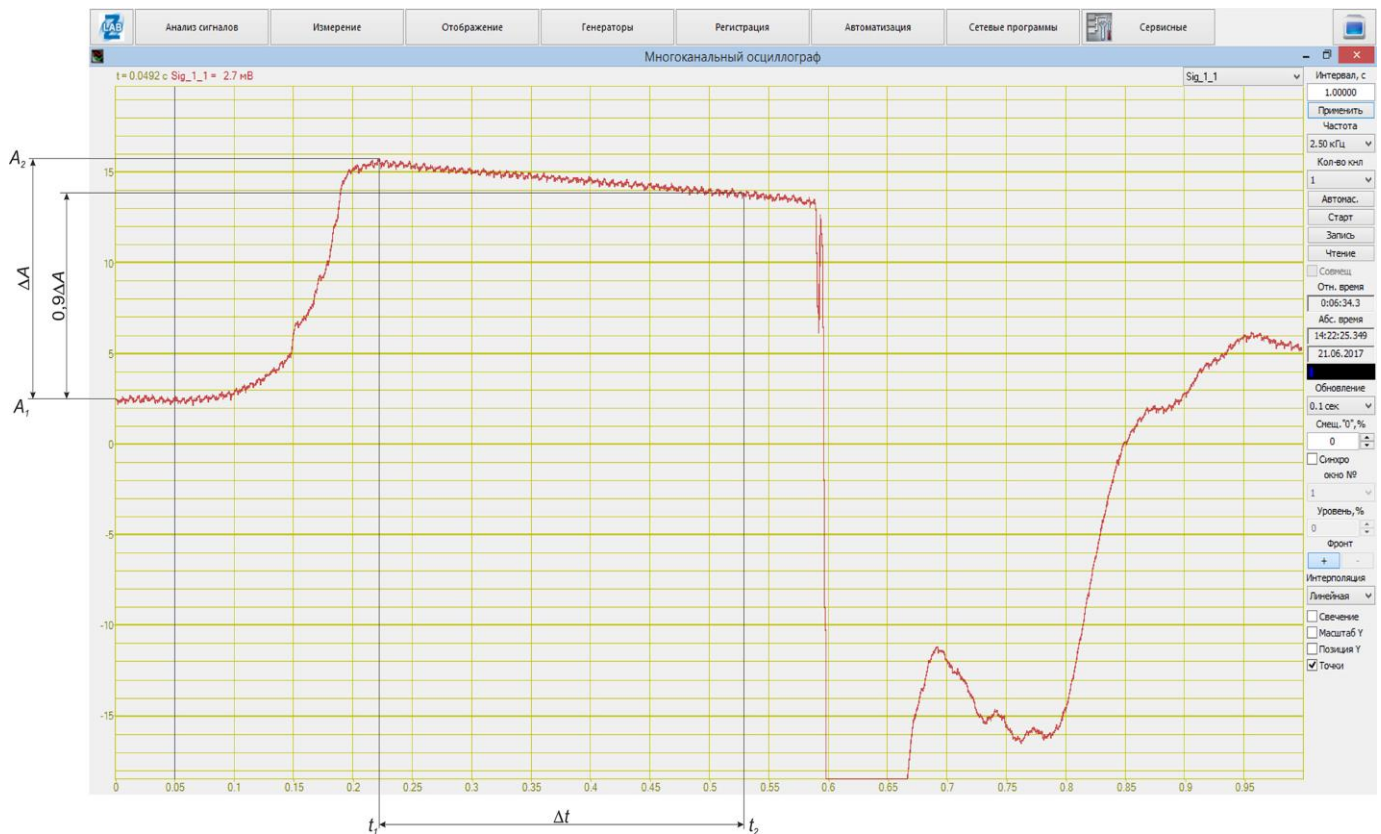
Рисунок Г.1 – Выходной сигнал датчика ускорения AP2013 при свободном падении
