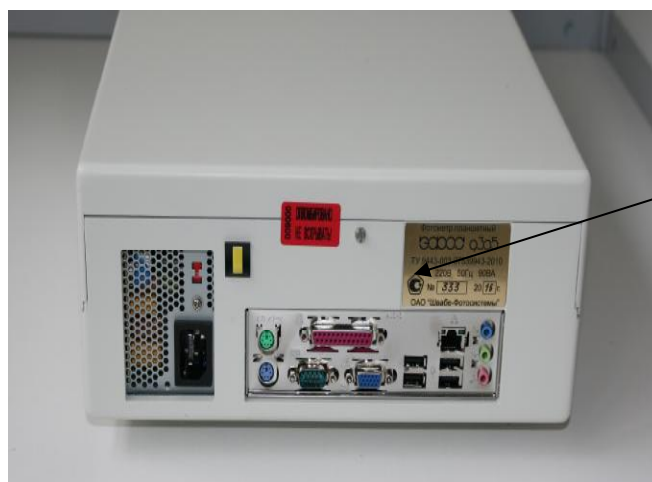
Рисунок 2 - Схема пломбировки от несанкционированного доступа
