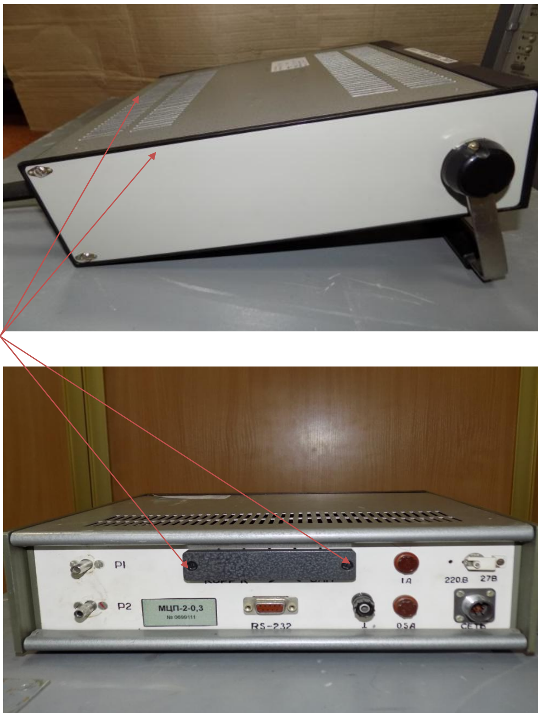
Рисунок 2 - Схема пломбировки манометра цифрового прецизионного МЦП-2-0,3 от несанкционированного доступа
