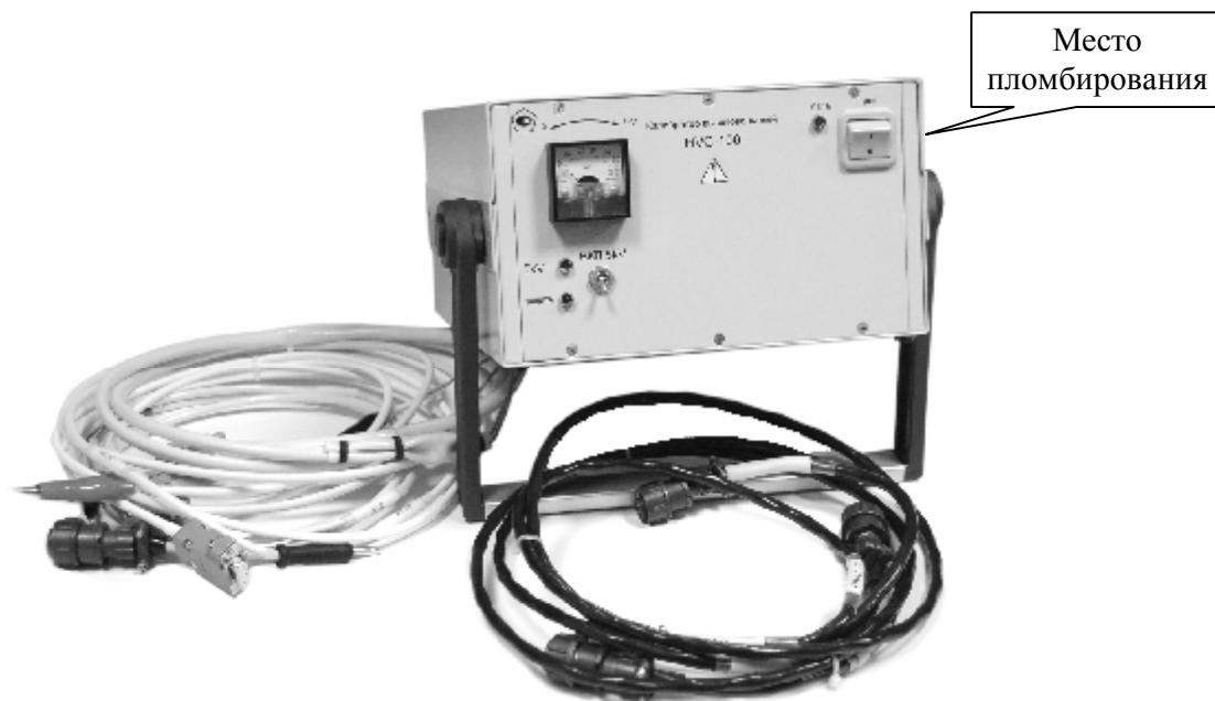
Общий вид прибора для поверки измерителей параметров движения электропоездов HVC-100
